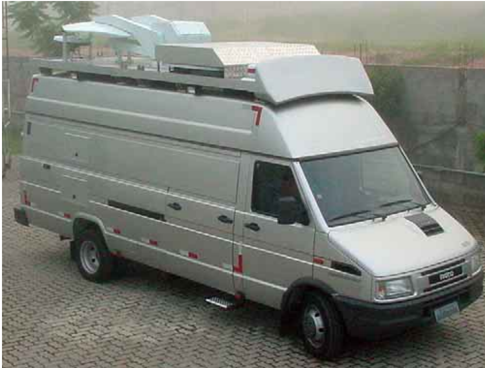
Plataforma de antenas e condicionadores de ar rooftop
