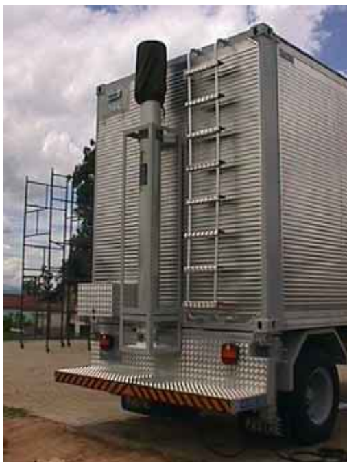
O mastro de 18,3m é transportado verticalmente sem exceder o limite de altura regulamentar.
