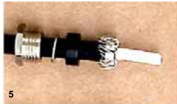
5 - Corte e retire o filme metálico excedente (RGC-58).
