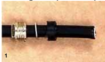
1 - Passe pelo cabo a bucha rosqueada, a arruela metálica, e o anel de borracha
