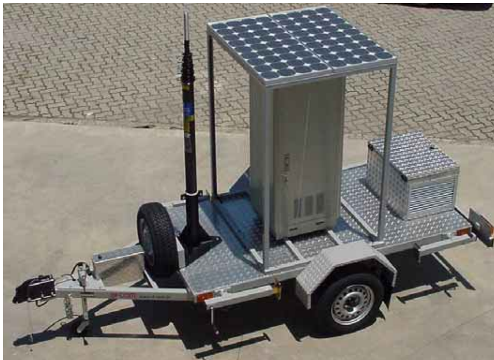
Sistema com mastro telescópico manual de 7,6m, dois módulos solares de 75W, gabinete e compartimento de gerador.
