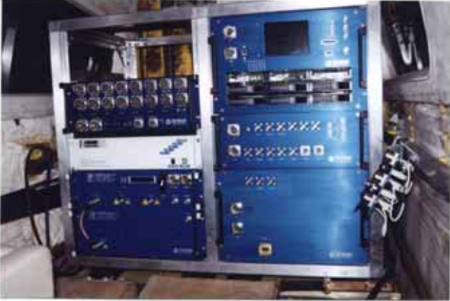
Rack e gavetas para radar de sensoamento remoto instalado em aeronave
