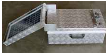
Caixa para sistema de coleta de dados de GPS, com módulo solar integrado.
