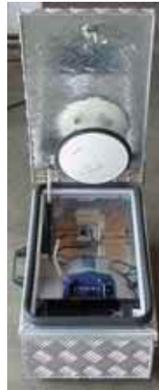
Caixa para sistema de coleta de dados de GPS, com módulo solar integrado.
