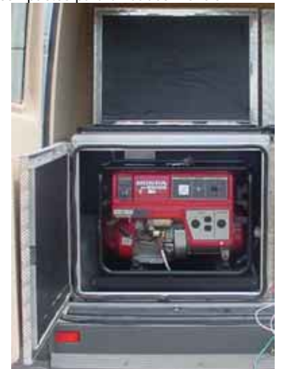
Compartimento de gerador para instalação veicular
