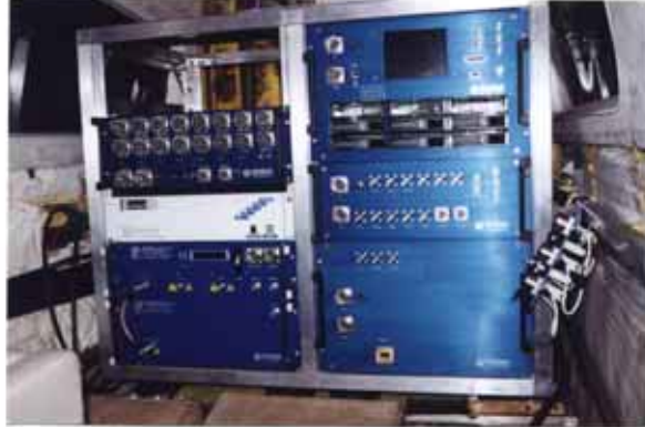
Rack e gavetas para radar de sensoriamento remoto instalado em aeronave
