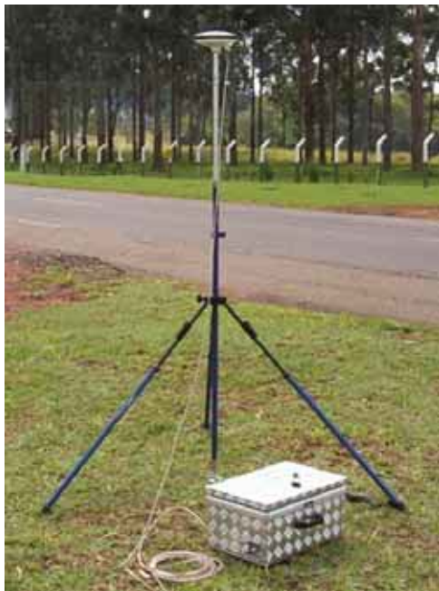
Caixa para sistema de coleta de dados de GPS, com módulo solar integrado.
