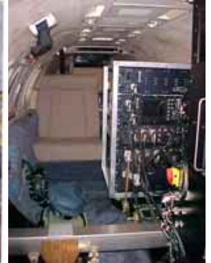
Rack e gavetas para radar de sensoriamento remoto instalado em aeronave
