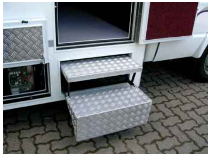
Escada com acionamento elétrico
